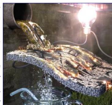
La membrana en forma de “sándwich” está compuesta por una capa porosa que filtra el agua en la parte inferior y un polímero conductor que genera electricidad en la superior. Está diseñada para depurar aguas contaminadas controlando la dirección del flujo del agua, la cual fluye perpendicularmente a la membrana y genera corriente continua por el movimiento de los iones a lo largo de la dirección horizontal.
